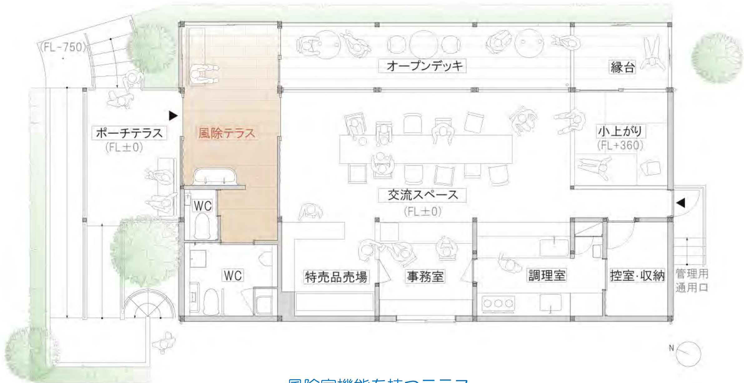
風除室機能を持つテラス
